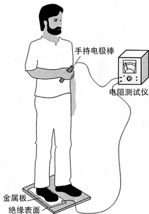
图 B.1 穿着时的电阻测试示意图
